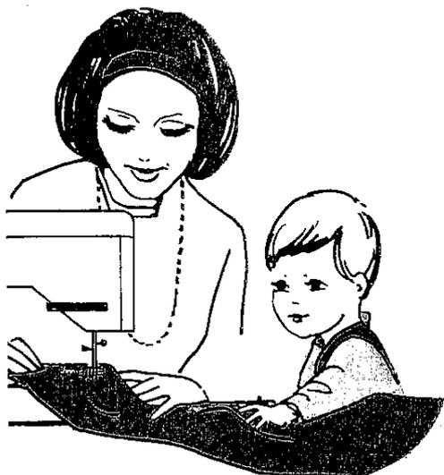
**1. Naht.** Die Stoffteile, die zusammengenäht werden sollen, liegen rechts auf rechts aufeinander. Der Rand des unteren Stoffes steht ca. 4 mm vor. Bitte achten Sie darauf, daß der Stoff gleichmäßig in den Kapper einläuft und daß sich nur der überstehende Rand umlegen darf.
