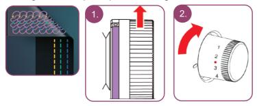
Kettengreiferfaden (violett) bildet Tunnel auf der Unterseite des Stoffes.
