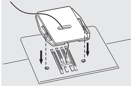
Montieren Sie die Stopfplatte.
