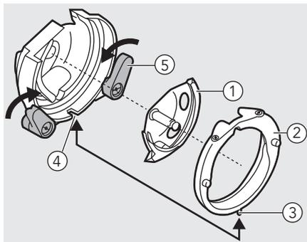
Greifer ersetzen. Bringen Sie die Bügel der Schiffchenbahn an und stellen Sie sicher, dass der untere Stift in die Vertiefung passt. Klappen Sie die beiden Hakenhalter zurück. Setzen Sie die Spulenkapsel und die Spule ein und tauschen Sie die Stichplatte aus.
