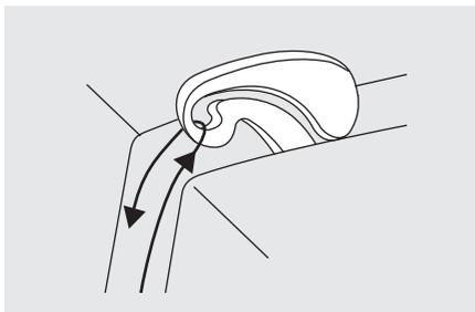
7. Am oberen Ende dieser Bewegung wird der Faden von rechts nach links durch die geschlitzte Öse des Fadenhebels und dann wieder nach unten geführt.
